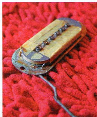
Die Konstruktion ähnelt der eines P-90-Pickups.
