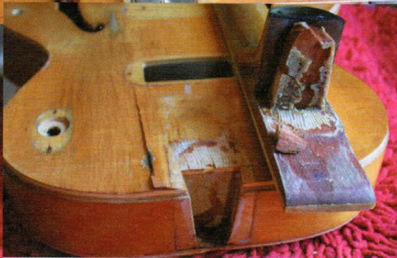
Der Hals hing nur noch an dem hier abgebrochenen kleinen Stück.
