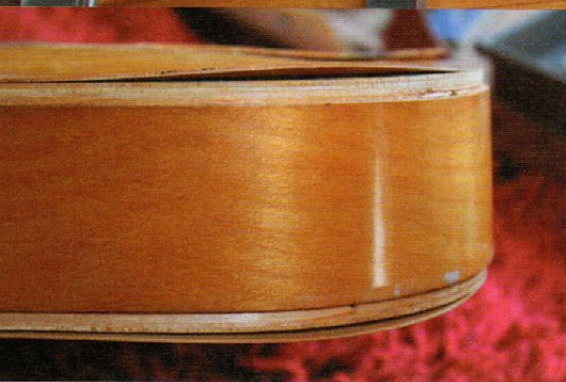
Die Sperrholzsichten hatten sich teilweise voneinander gelöst.
