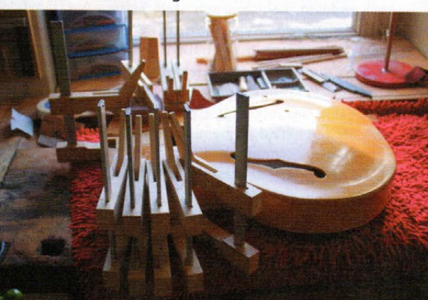
Verleimen der gelösten Schichten.
